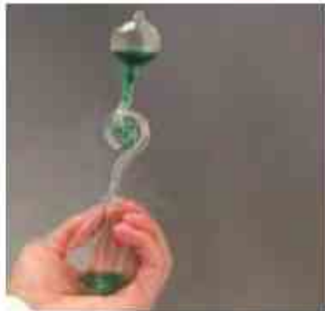
شکل ۴-۳۴ با در دست گرفتن حباب شیشه‌ای و گرم کردن آن، مایع رنگی در لوله ماریچ بالا می‌رود.
